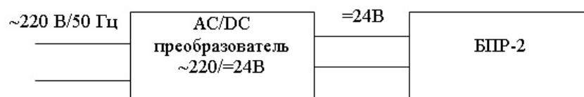
Рисунок 6 – Схема подключения блока питания и регистрации БПР-2Т к сети ~ 220В, 50Гц.
