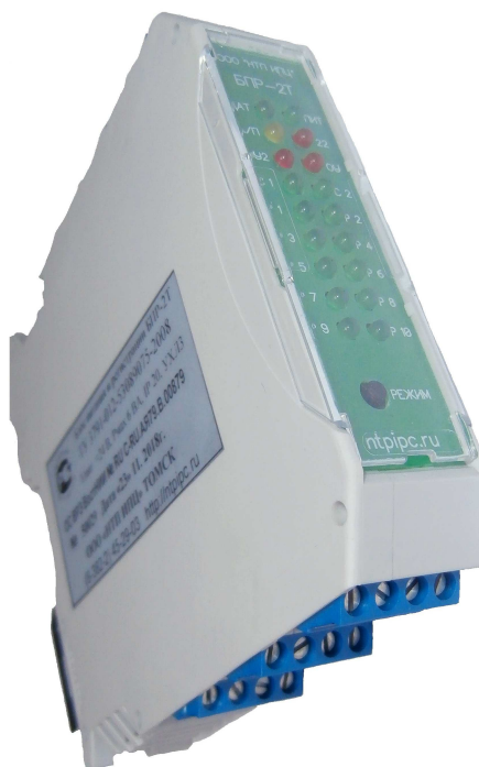
Рисунок 1 – Блок питания и регистрации БПР-2Т. Внешний вид
