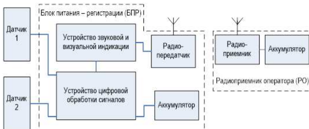
Рисунок 3 – Функциональная схема переносного сигнализатора исполнения «РЕПЕР-3В»
