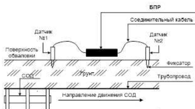
Рисунок 6 – Схема установки переносного сигнализатора «РЕПЕР-3В».
