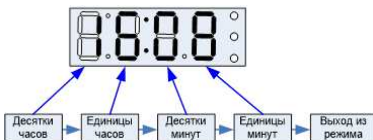
Рисунок 20 – Последовательность действий для установки времени.
