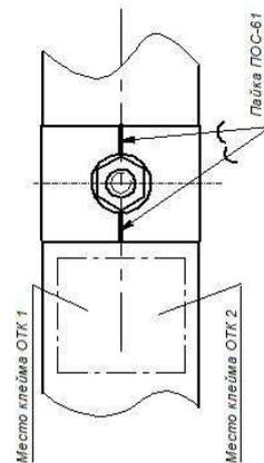
Рисунок 14 – Чертеж средств взрывозащиты сигнализатора МДПС-3 исп. 02.
