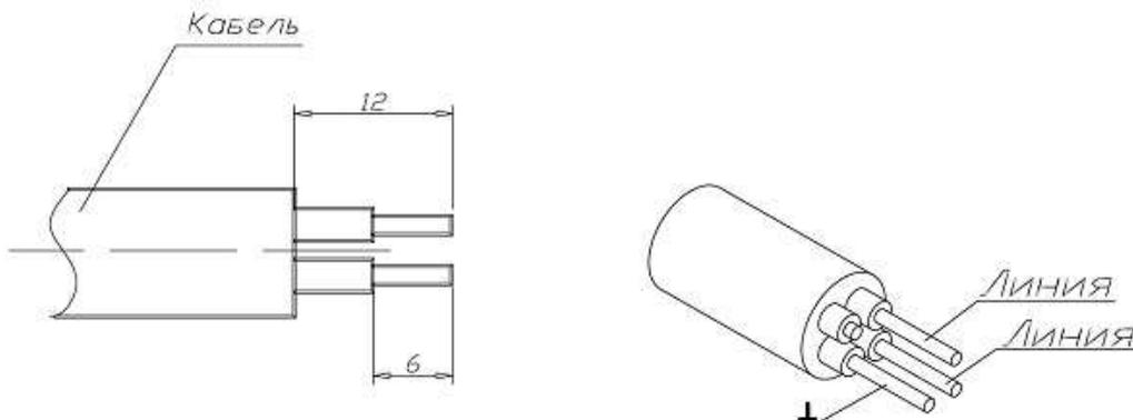
Рисунок 21 – Разделка кабеля для монтажа в датчики исполнения ИПЦЭ.418128.001-01, ИПЦЭ.418128.001-03, ИПЦЭ.418128.001-04.
