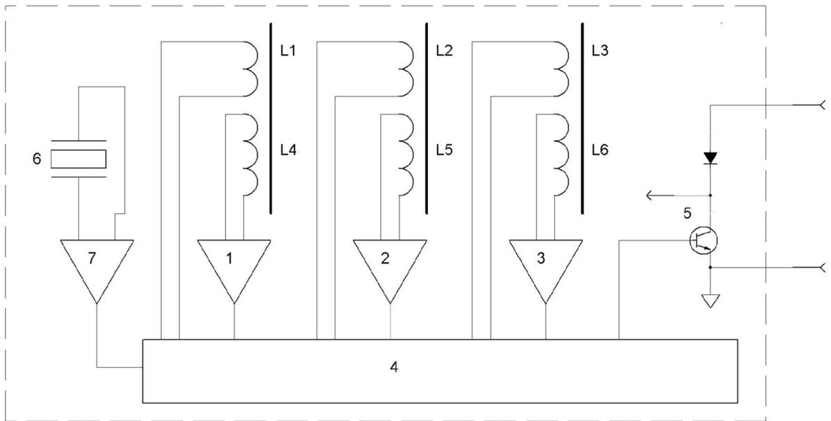
Рисунок 2 – Функциональная схема датчика исполнения ИПЦЭ418128.002-01, ИПЦЭ418128.002-01Т, ИПЦЭ418128.002-02, ИПЦЭ418128.002-04, ИПЦЭ418128.002-04Т сигнализатора МДПС-3.
