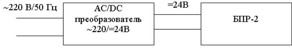
Рисунок 7 – Схема подключения блока питания и регистрации БПР-2 к сети ~ 220В.
