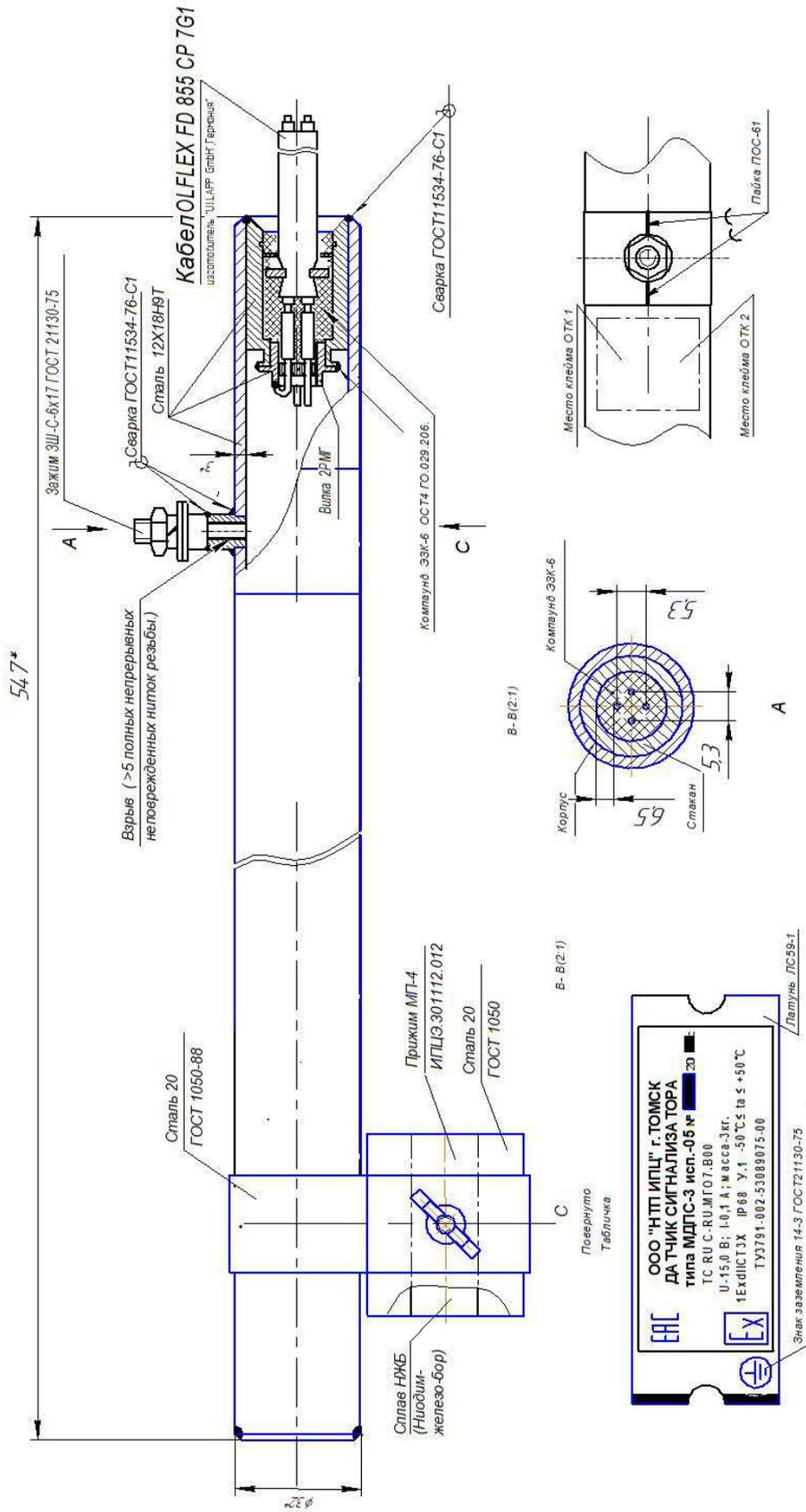
Рисунок 17 – Чертёж средств взрывозащиты сигнализатора МДПС-3 исп. 05.
