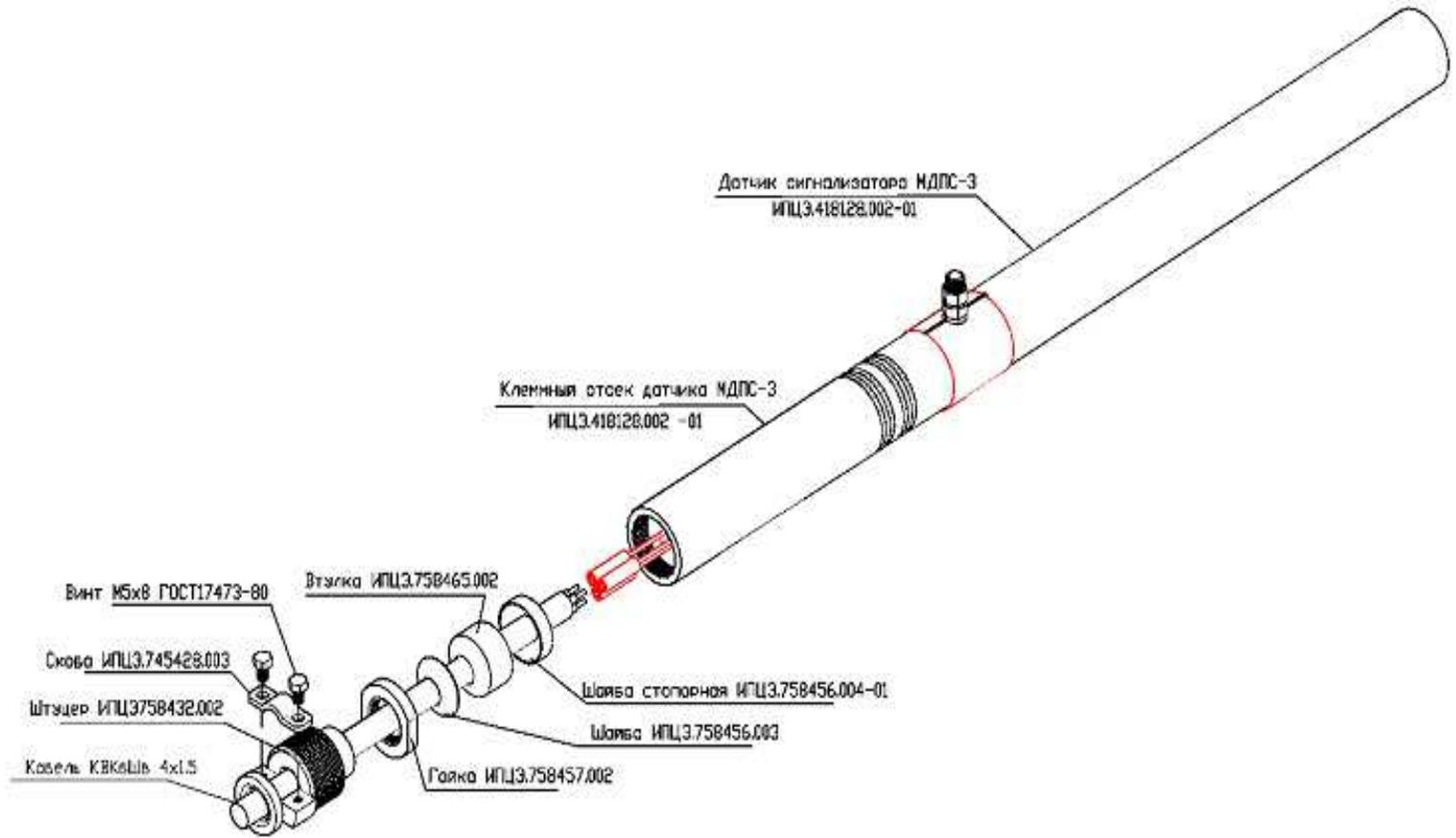
Рисунок 22 – Схема монтажа датчика сигнализатора МДПС-3 ИПЦЭ.418128.002-01
