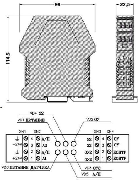
Рисунок 6 – Внешний вид и установочные размеры блока питания и регистрации БПР-2 сигнализатора МДПС-3
