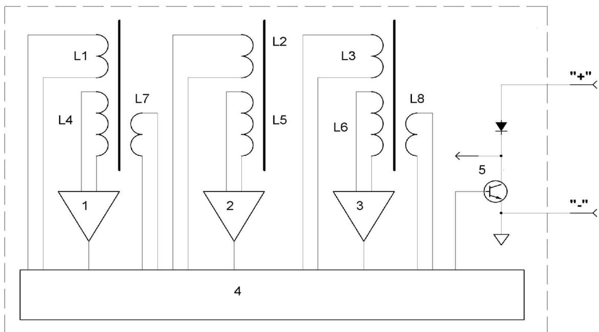
Рисунок 3 – Функциональная схема датчика исполнения ИПЦЭ418128.002-03 сигнализатора МДПС-3
