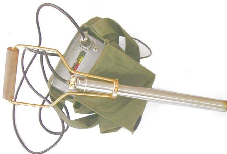
Рис. 1 Внешний вид приемника ПМ-2
