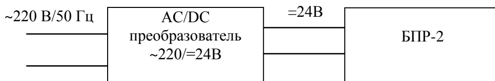
Рисунок 6 Схема подключения блока питания и регистрации БПР-2 к сети ~ 220В.
