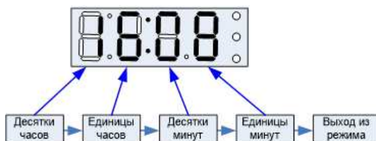
Рисунок 20 – Последовательность действий для установки времени.
