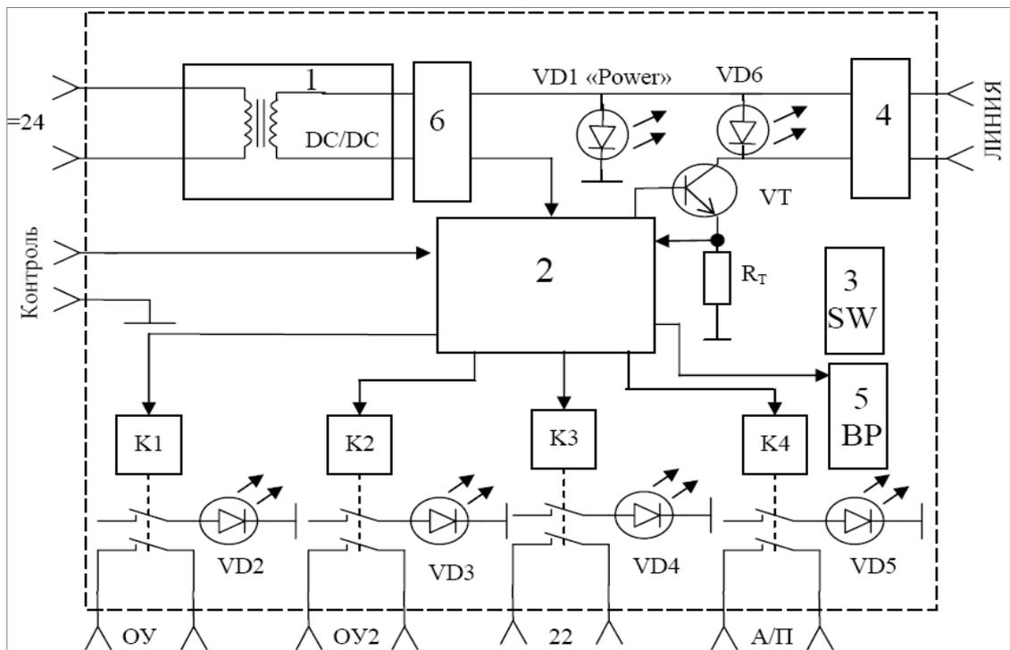
Рисунок 4 Функциональная схема блока питания и регистрации БПР-2.
