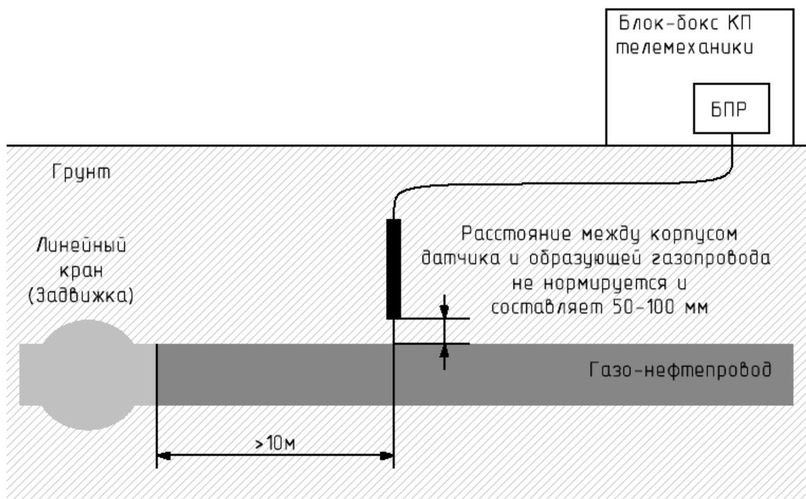
Рисунок 10 Установка датчика исполнения ИПЦЭ418128.002-03 сигнализатора МДПС-3 в обваловку трубы нефте-газопровода.
