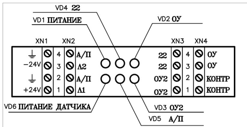
Рисунок 6 Внешний вид и установочные размеры блока питания и регистрации БПР-2 сигнализатора МДПС-3.
