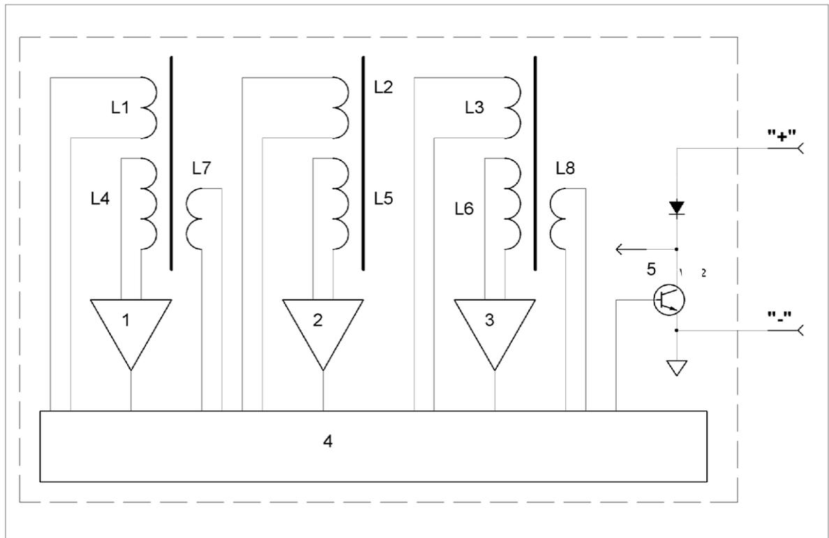
Рисунок 3 Функциональная схема датчика исполнения ИПЦЭ418128.002-03 сигнализатора МДПС-3.
