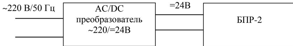
Рисунок 7 Схема подключения блока питания и регистрации БПР-2 к сети ~ 220В.
