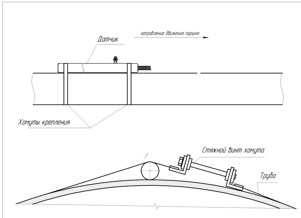
Рисунок 9 Установка датчика исполнения ИПЦЭ418128.002-01, ИПЦЭ418128.002-04 сигнализатора МДПС-3 на тело трубы нефте-газопровода с помощью хомутов-стяжек.
