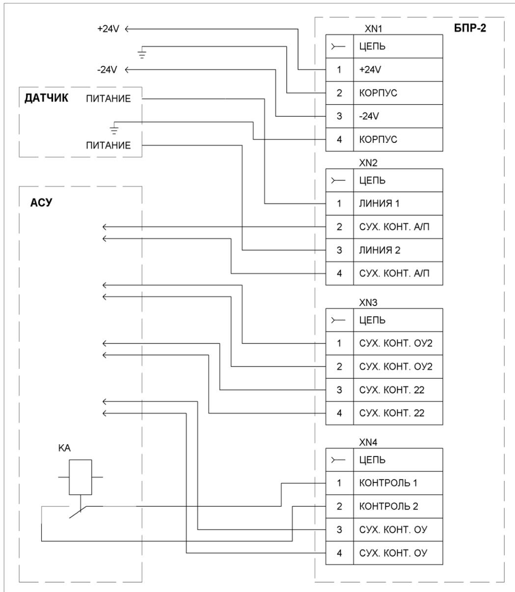
Рисунок 18 Монтажная схема сигнализатора МДПС-3 в составе с блоком питания и регистрации БПР-2.
