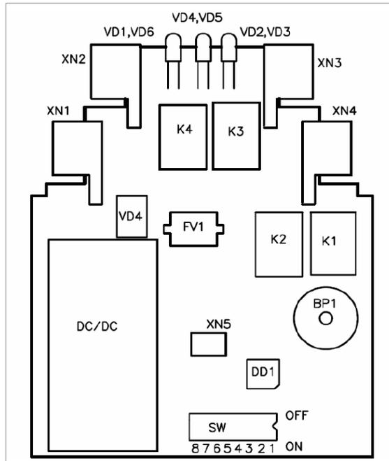
Рисунок 5 Расположение элементов коммутации и индикации на плате БПР-2 сигнализатора МДПС-3.
