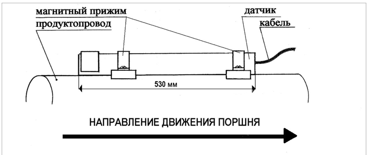
Рисунок 8 Установка датчика исполнения ИПЦЭ418128.002, ИПЦЭ418128.002-05 сигнализатора МДПС-3 на тело трубы нефте-газопровода с мощью магнитных прижимов.
