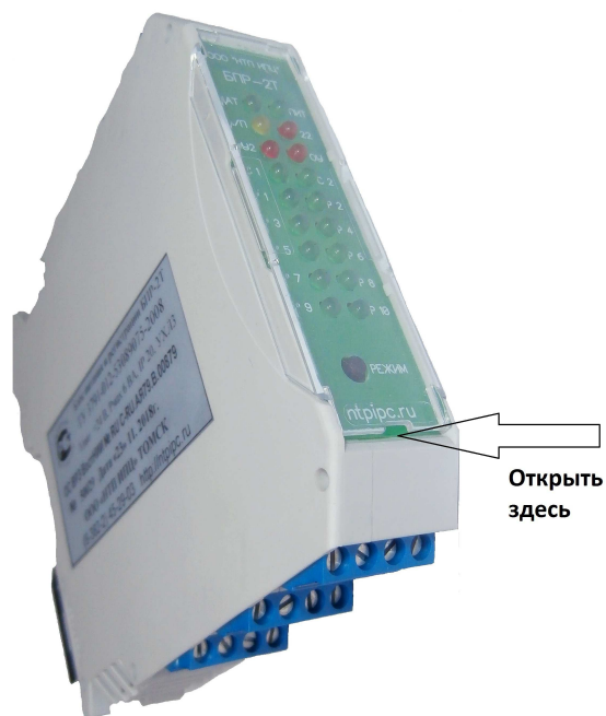
Рисунок 7 – Снятие прозрачного стекла передней панели БПР
