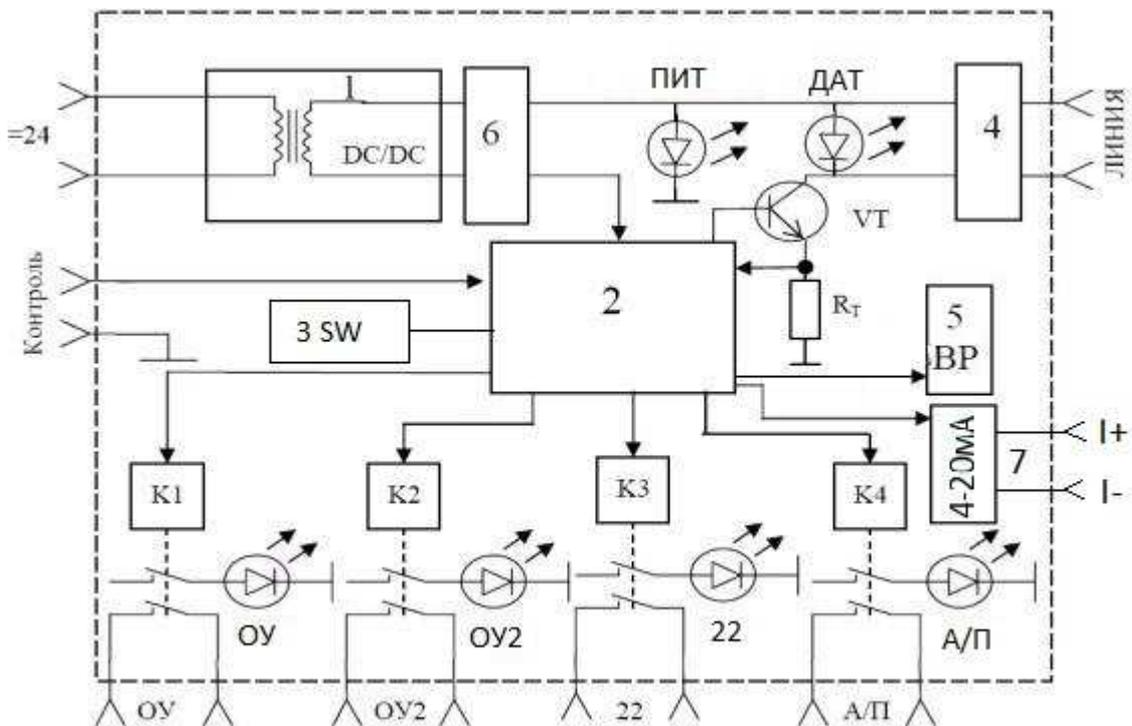
Рисунок 2 – Функциональная схема блока питания и регистрации БПР-2Т.
