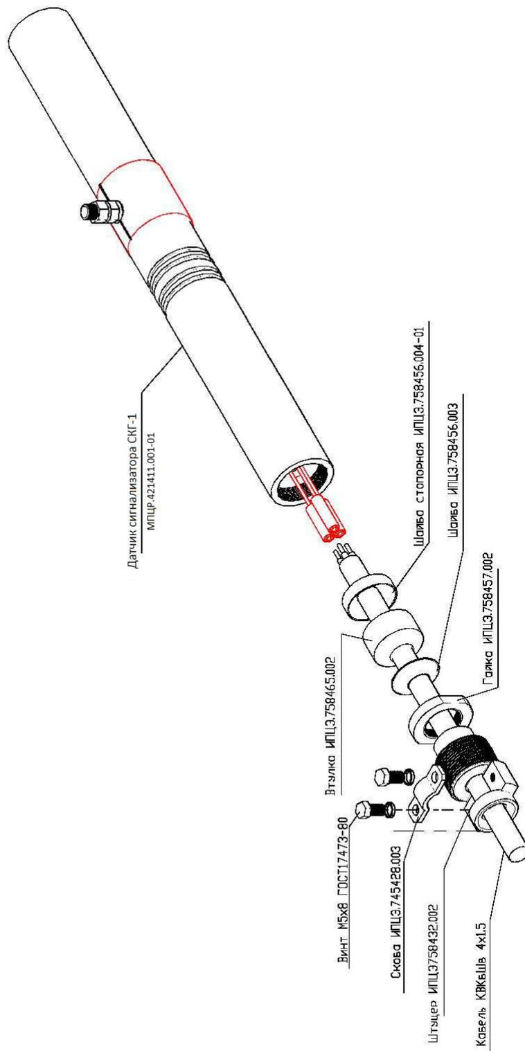
Рисунок 15 – Схема монтажа датчика сигнализатора контроля герметичности СКГ-1
