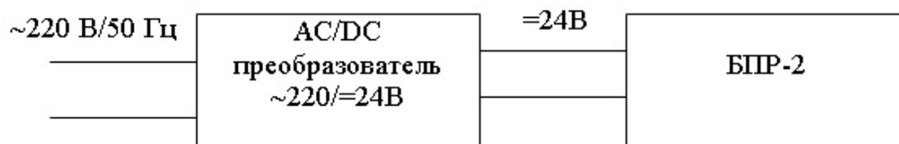
Рисунок 8 – Схема подключения блока питания и регистрации БПР-2/БПР-2Т к сети ~ 220В.
