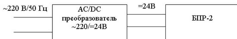
Рисунок 5 – Схема подключения блока питания и регистрации ДПС-9А к сети ~ 220В.
